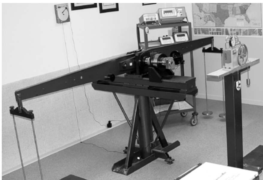
Установка для калибровки датчиков момента до 5000 \text{ Н} \cdot \text{м}
