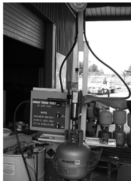
Клапанное управление газовым баллоном и отключение с использованием PT1500
