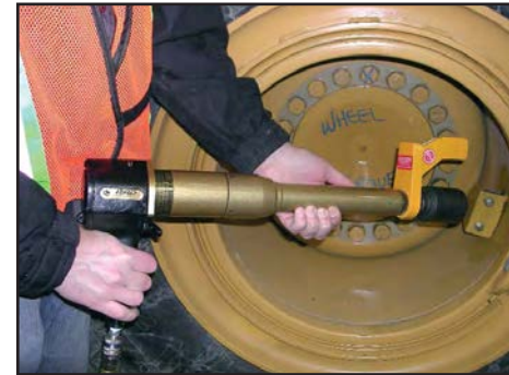
RAD 14GX (13549), 305mm “удлинитель” с реакционной опорой
